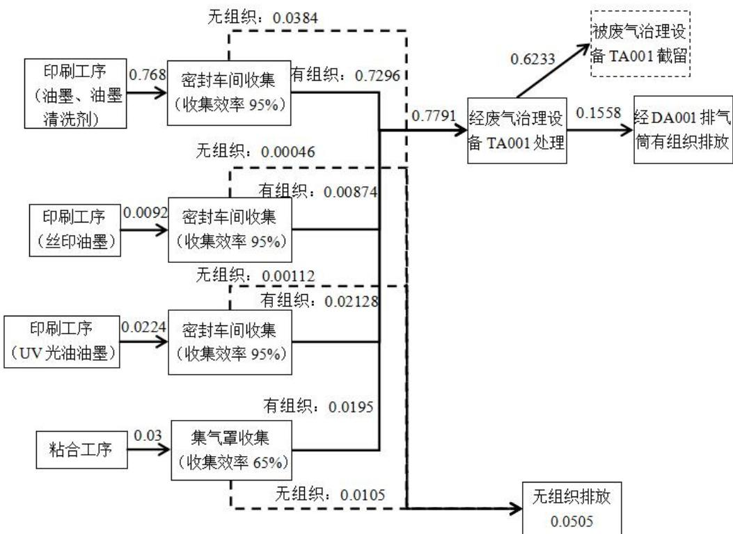
图 2 项目 VOCs 平衡图 (单位: t/a)
