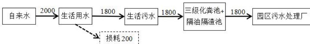
图 1 项目水平衡图（单位： $\text{m}^3/\text{a}$ ）
